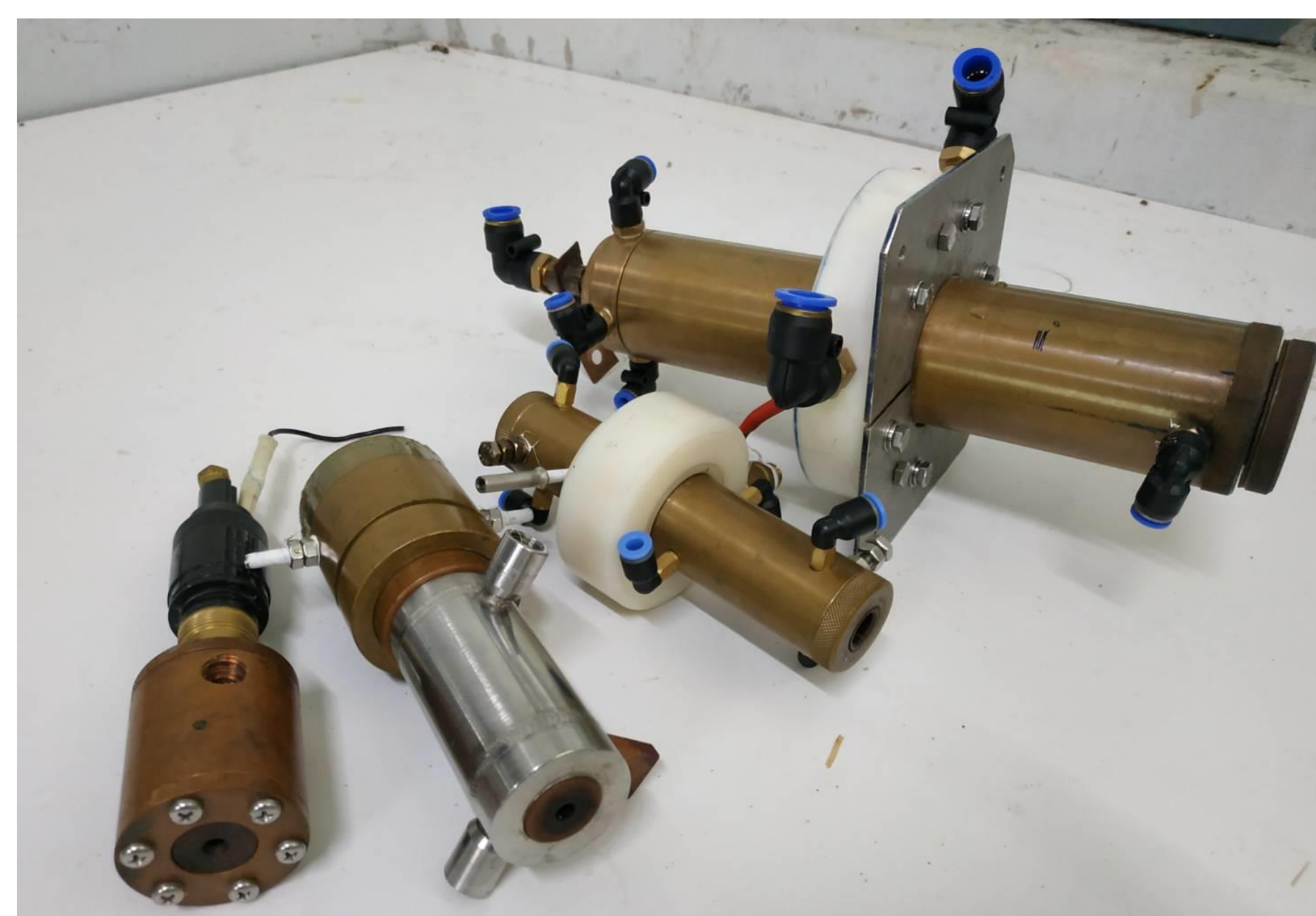
ต้นแบบการพัฒนาหัวทอขนาด 5 kW – 30 kW
