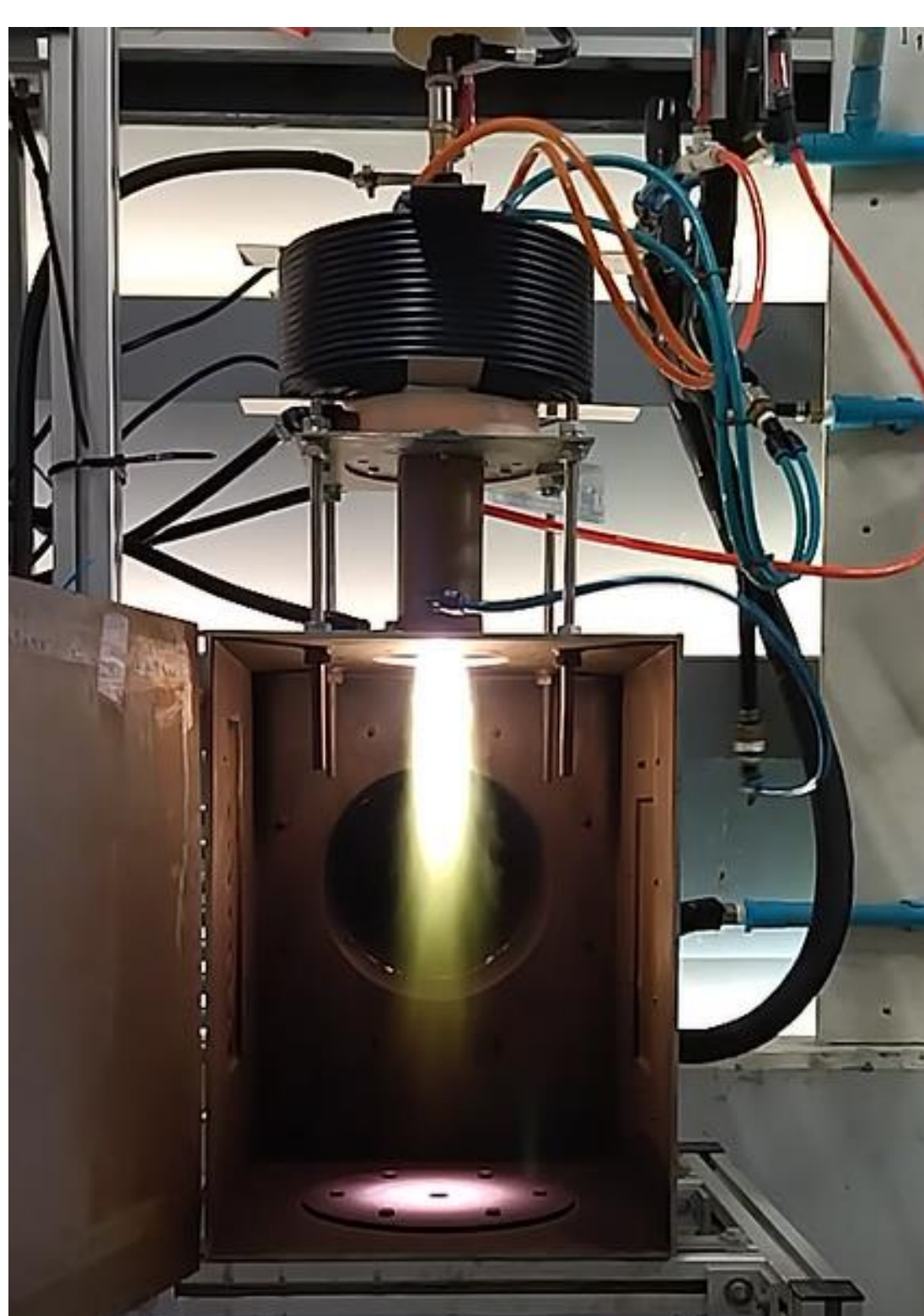
การทดสอบพลาสมาทอขนาด 30 kW
